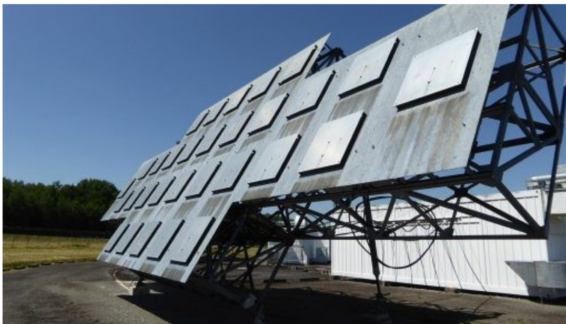
Figure 2. Foto di uno dei 4 pannelli costituenti il GRAVES.
