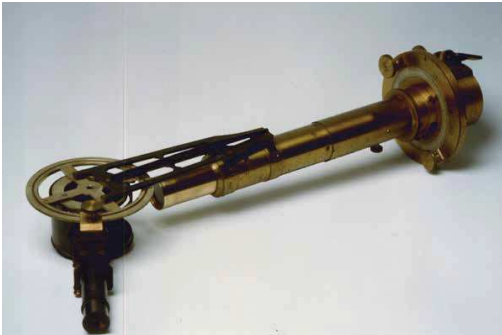
Pa. 04. SPETTROSCOPIO A RETICOLO DI DIFFRAZIONE Fratelli Brassart, Roma (Italia) 1884 ottone, ferro; lunghezza totale 600 mm INAF-Osservatorio Astronomico di Palermo*
