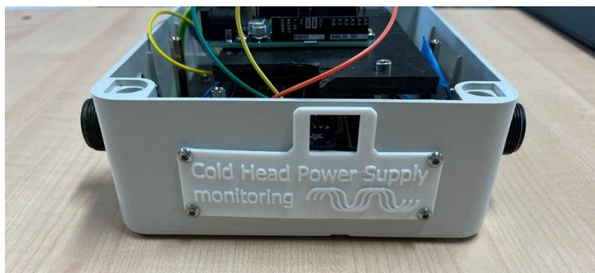
Figura 5. Connettore alimentazione 220 V e connettore Ethernet, sopra e sotto rispettivamente.
