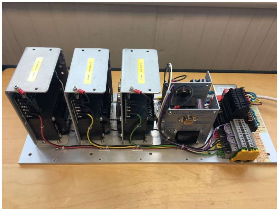
Fig. 1 – Assemblaggio della sezione di alimentazione
