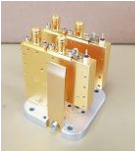
Fig. I.6 L'insieme delle conversioni di frequenza per le due polarizzazioni di ciascun pixel del multifeed.
