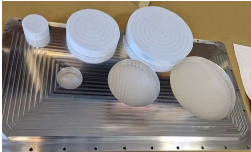
Fig. 4.5: Dischi di foam sulla finestra prima dell'incollaggio.
