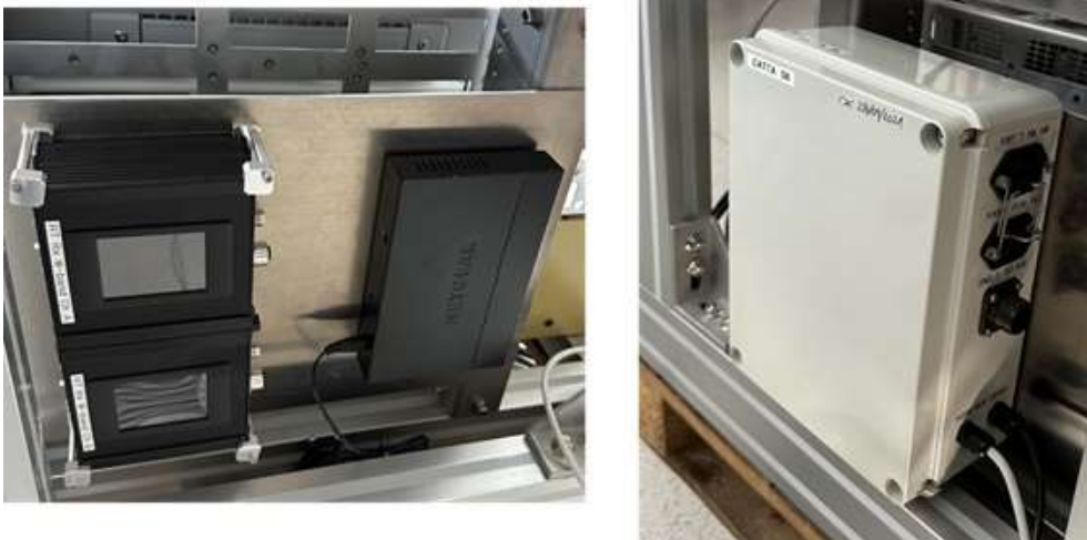
Fig. 2.8: Alimentatori per LNA in parte calda del Banda W (a sinistra) e Cryo Power Box (a destra).
