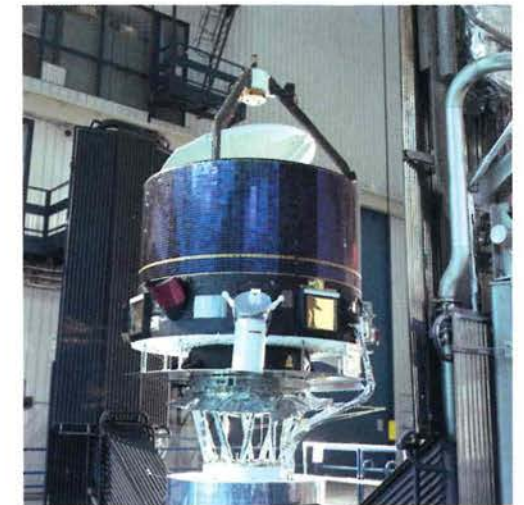
La sonda rivestita dei pannelli solari. Nella piattaforma immediatamente sottostante è visibile, al centro (si veda il cilindro bianco), la Halley Multicolour Camera progettata per fare foto ravvicinate del nucleo cometario.
