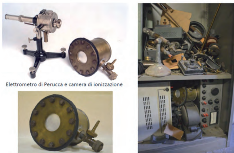
Fig. 7. L'elettrometro di Perucca, la camera di ionizzazione e il luogo in cui sono stati ritrovati
