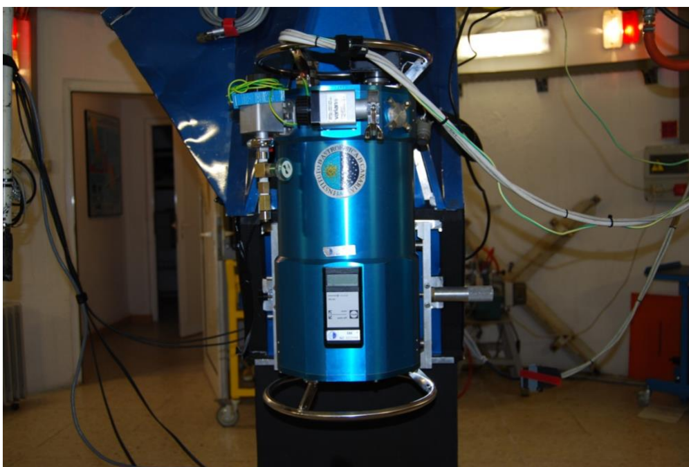
Figura 2. La camera infrarossa (CAIN) montata sul telescopio Carlos Sanchez (TCS)
