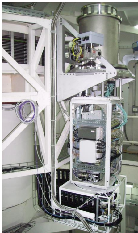
Fig. 1.1 Il multifeed K-band attualmente montato sul tamburo gregoriano di SRT
