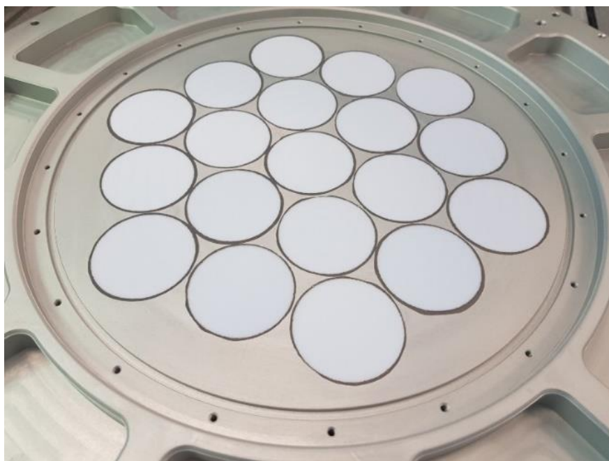
Fig. 2.1 Vista delle 19 finestre da vuoto
