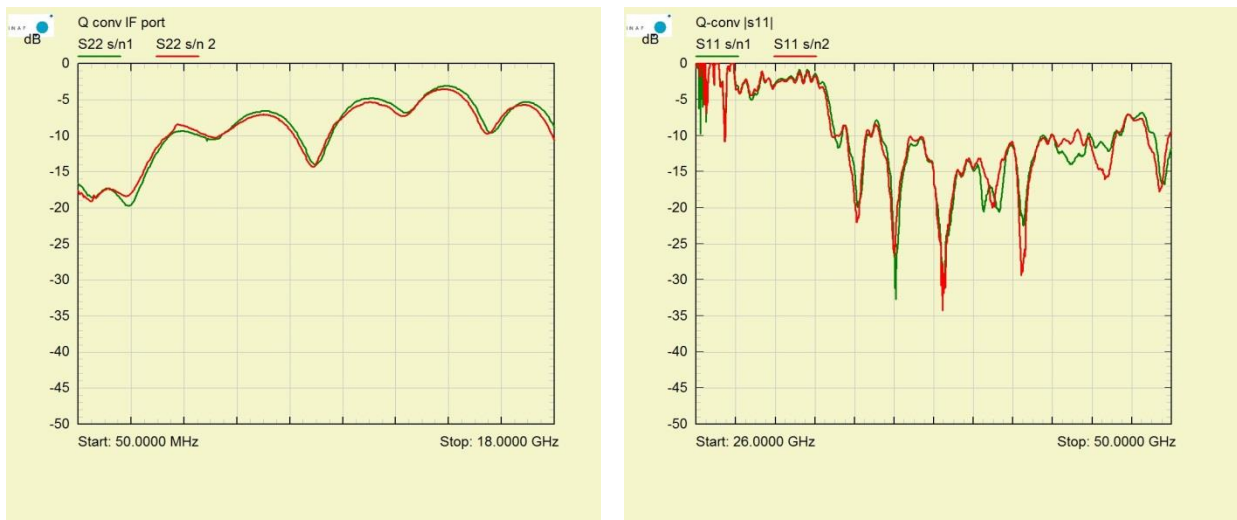
Fig. 4.9 Misura di S_{11} (a destra) e S_{22} (a sinistra) sui due prototipi
