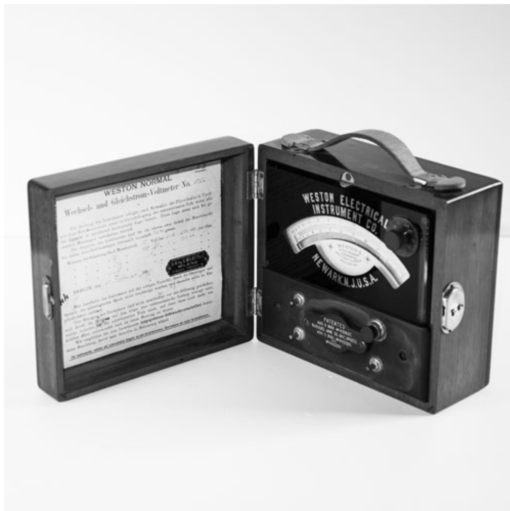
Fig. 3 – Milliampmetro Weston Electrical Instrument Co, Newark, N. J. USA. Dimensioni larghezza cm 20, profondità cm 18, altezza cm 11. Lo strumento, inserito in scatola di legno, è del tipo ideato da Edward Weston alla fine dell'Ottocento. L'equipaggio mobile è composto da una bobina impregnata fra i poli di un potente magnete permanente. Questi strumenti a misura diretta, solidi, affidabili, erano diffusissimi e in forma più moderna sono utilizzati ancora oggi. [Dipartimento di Fisica e Astronomia, Università di Firenze]
