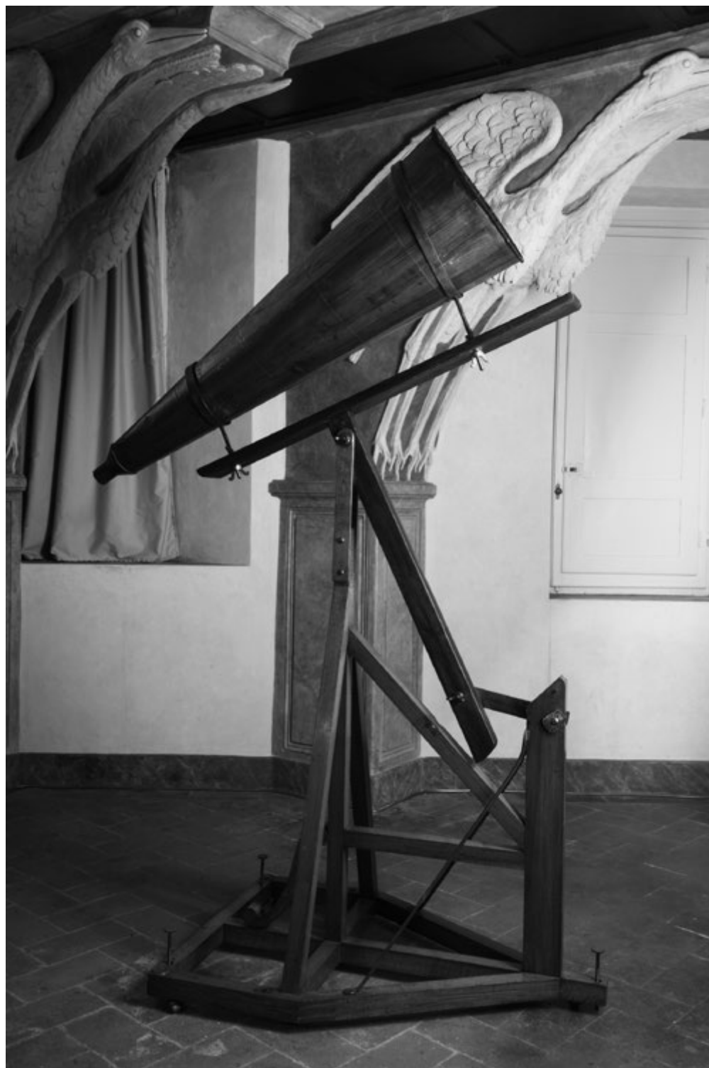
Fig. 7 – Tubo di telescopio con spettroscopio a prisma. Fu ideato da Giovan Battista Donati per gli studi di spettroscopia stellare, 1859 ca. [Foto Saulo Bambi]
