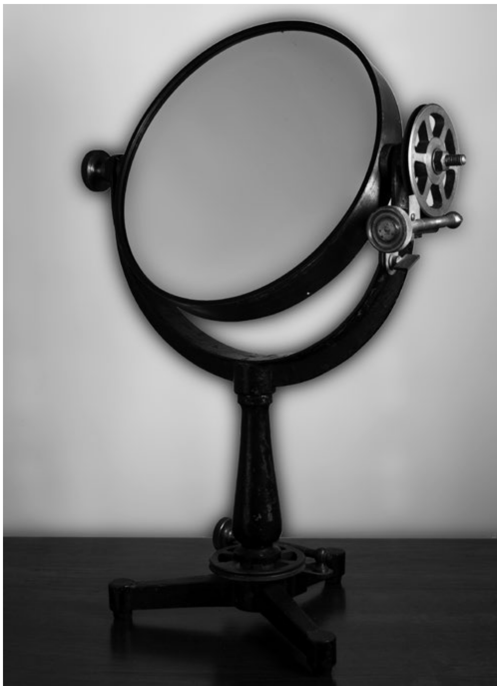
Fig. 12 – Specchio sferico metallico di 32 cm di diametro e 6 m di focale, probabilmente costruito da Amici a Modena nel 1825.
