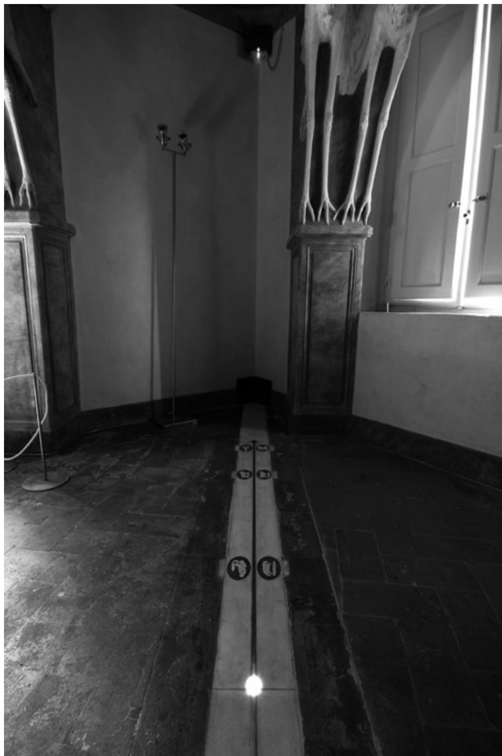
Fig. 2 – La meridiana a camera oscura.
