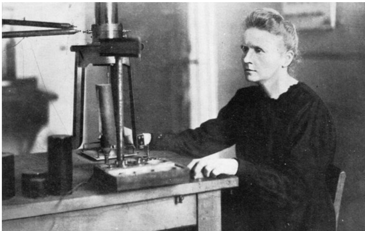
Fig. 2 – Apparecchio a quarzo piezoelettrico, 1910 circa, costruito dalla Società Centrale de Produits Chimiques, Paris. Dimensioni: diametro base cm 30, altezza cm 60. Questo apparecchio è parte del sistema ideato da Pierre e Marie Curie alla fine del XIX secolo per le misure della radioattività dell'uranio, che comprendeva anche un elettrometro e una camera di ionizzazione. Esso contiene una lamina di quarzo che per le sue proprietà piezoelettriche genera una corrente quando, tramite pesi, è sottoposto a trazione. Tale corrente veniva a compensare quella generata dalle radiazioni ionizzanti ed era così possibile determinare con precisione la radioattività del campione in esame. [Dipartimento di Fisica e Astronomia, Università di Firenze]. Nella seconda immagine, Marie Curie negli anni '30 al lavoro con uno strumento del tipo illustrato.
