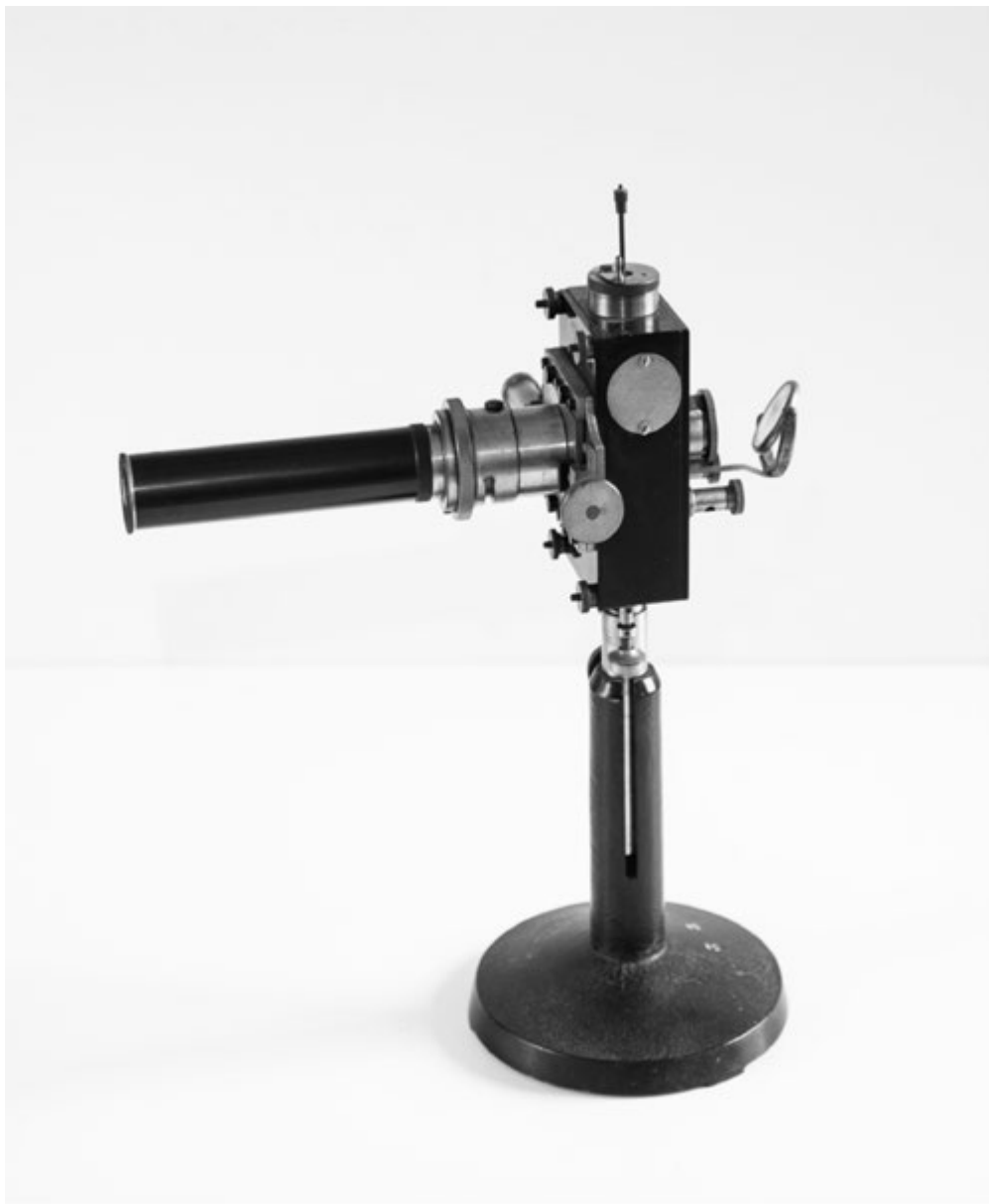
Fig. 6 – Elettrometro Perucca. Costruttore: Spindler-Hoyer, Goettingen, 1930 circa. Dimensioni: diametro base cm 13, larghezza cm 25, altezza cm 32. Questo elettrometro estremamente sensibile fu ideato dal fisico italiano Eligio Perucca (1890-1965) verso il 1930. L'equipaggio mobile (al quale è applicato il potenziale da misurare) è composto da un filo dorato di vetro di silice al quale è fissato un leggerissimo indicatore posto fra le piastrine alle quale si applica la tensione ausiliaria. L'azione ponderomotrice fra l'equipaggio mobile e le piastrine provoca una torsione del filo e il conseguente spostamento dell'indice che viene osservato tramite un microscopio. [Dipartimento di Fisica e Astronomia, Università di Firenze]
