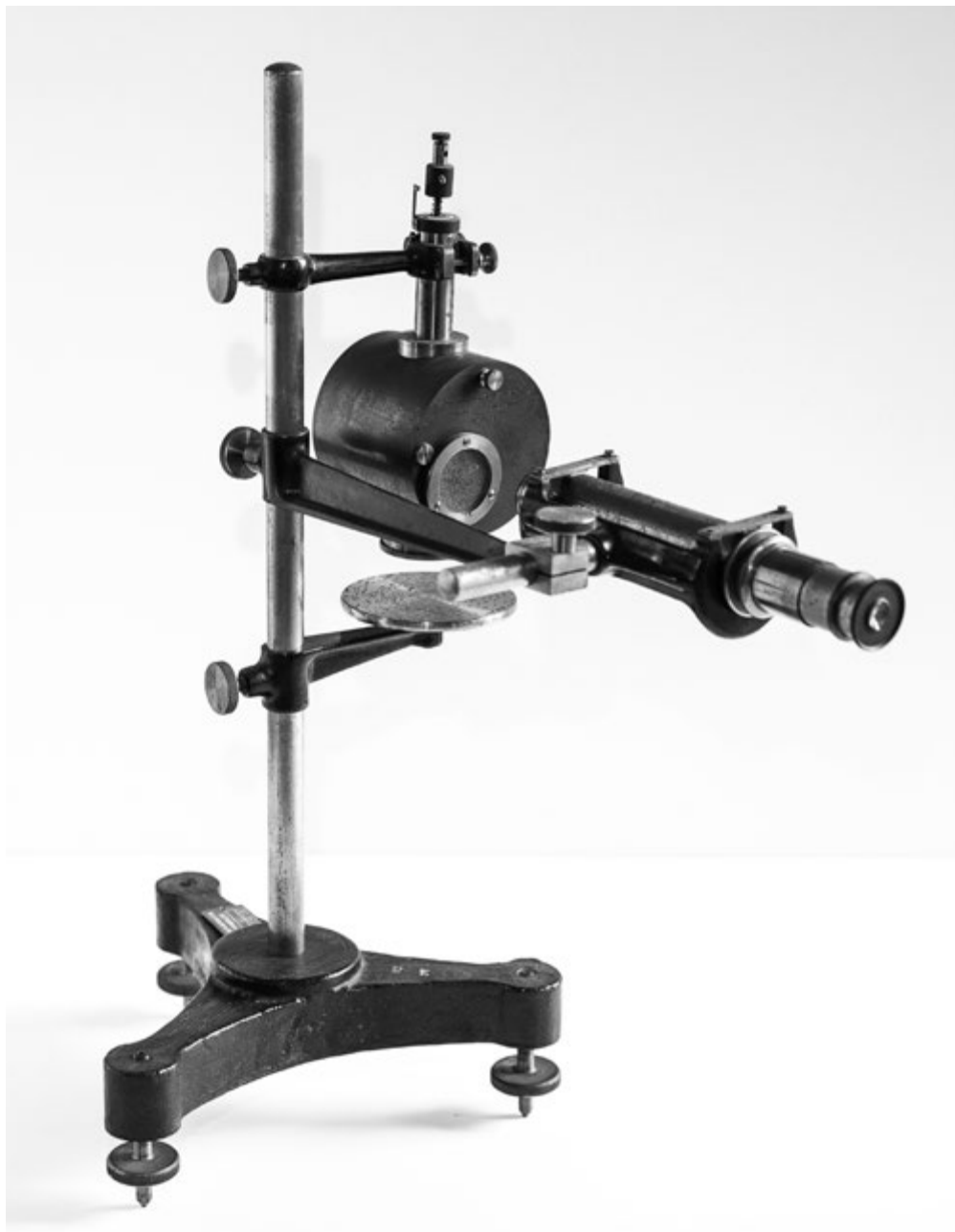
Fig. 1 – Micro-elettroscopio di Wilson, costruito dalla ditta The Cambridge Scientific Instrument Co Ltd, Cambridge, England, 1920 circa. Questo tipo di elettroscopio fu ideato dal fisico britannico Charles Thomson Rees Wilson, famoso tra l'altro per l'invenzione della camera a nebbia. È essenzialmente un elettroscopio a foglia d'oro utilizzato specialmente per misure di ionizzazione indotta dalla radioattività. Il campione da studiare viene posto su di un piattello sotto lo strumento e la posizione della foglia d'oro (che costituisce l'equipaggio mobile) viene osservata tramite un microscopio. [Dipartimento di Fisica e Astronomia, Università di Firenze]
