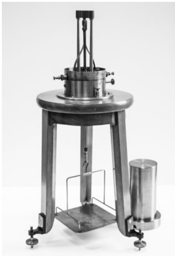
Fig. 2 – Apparecchio a quarzo piezoelettrico, 1910 circa, costruito dalla Società Centrale de Produits Chimiques, Paris. Dimensioni: diametro base cm 30, altezza cm 60. Questo apparecchio è parte del sistema ideato da Pierre e Marie Curie alla fine del XIX secolo per le misure della radioattività dell'uranio, che comprendeva anche un elettrometro e una camera di ionizzazione. Esso contiene una lamina di quarzo che per le sue proprietà piezoelettriche genera una corrente quando, tramite pesi, è sottoposto a trazione. Tale corrente veniva a compensare quella generata dalle radiazioni ionizzanti ed era così possibile determinare con precisione la radioattività del campione in esame. [Dipartimento di Fisica e Astronomia, Università di Firenze]. Nella seconda immagine, Marie Curie negli anni '30 al lavoro con uno strumento del tipo illustrato.
