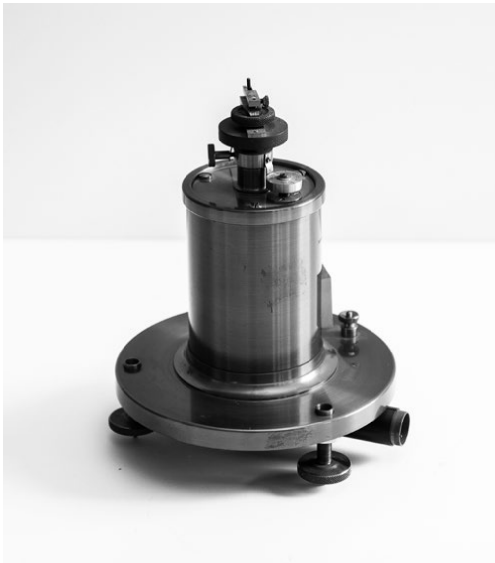
Fig. 5 – Elettrometro Compton, costruito dalla Cambridge Instrument Co. Ltd, England, 1930 circa. Dimensioni: diametro base cm 17, altezza cm 23. Si tratta di un elettrometro a quadranti nel quale l'equipaggio mobile è costituito da un settore di alluminio sospeso al centro di due coppie di quadranti. Lo strumento ideato dal fisico americano Arthur Compton è una modifica dello strumento proposto da Dolezalek e diversamente da questo permette di modificare la posizione di uno dei quadranti. [Dipartimento di Fisica e Astronomia, Università di Firenze]
