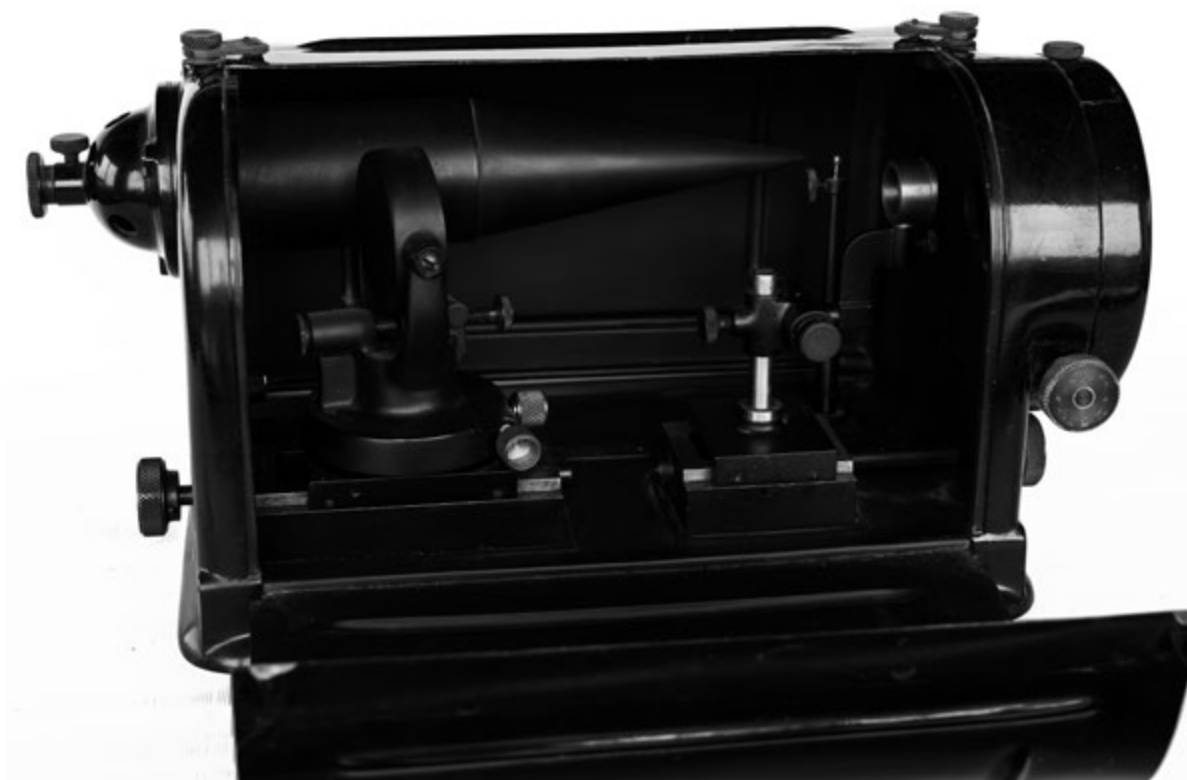
Fig. 9 – Risolvimetro interferenziale; strumento (progetto R. Brusciaglioni) utilizzato nel 1938 all'Istituto di Ottica dalla dott. ssa Crinò per misurare il potere risolutivo delle emulsioni fotografiche.
