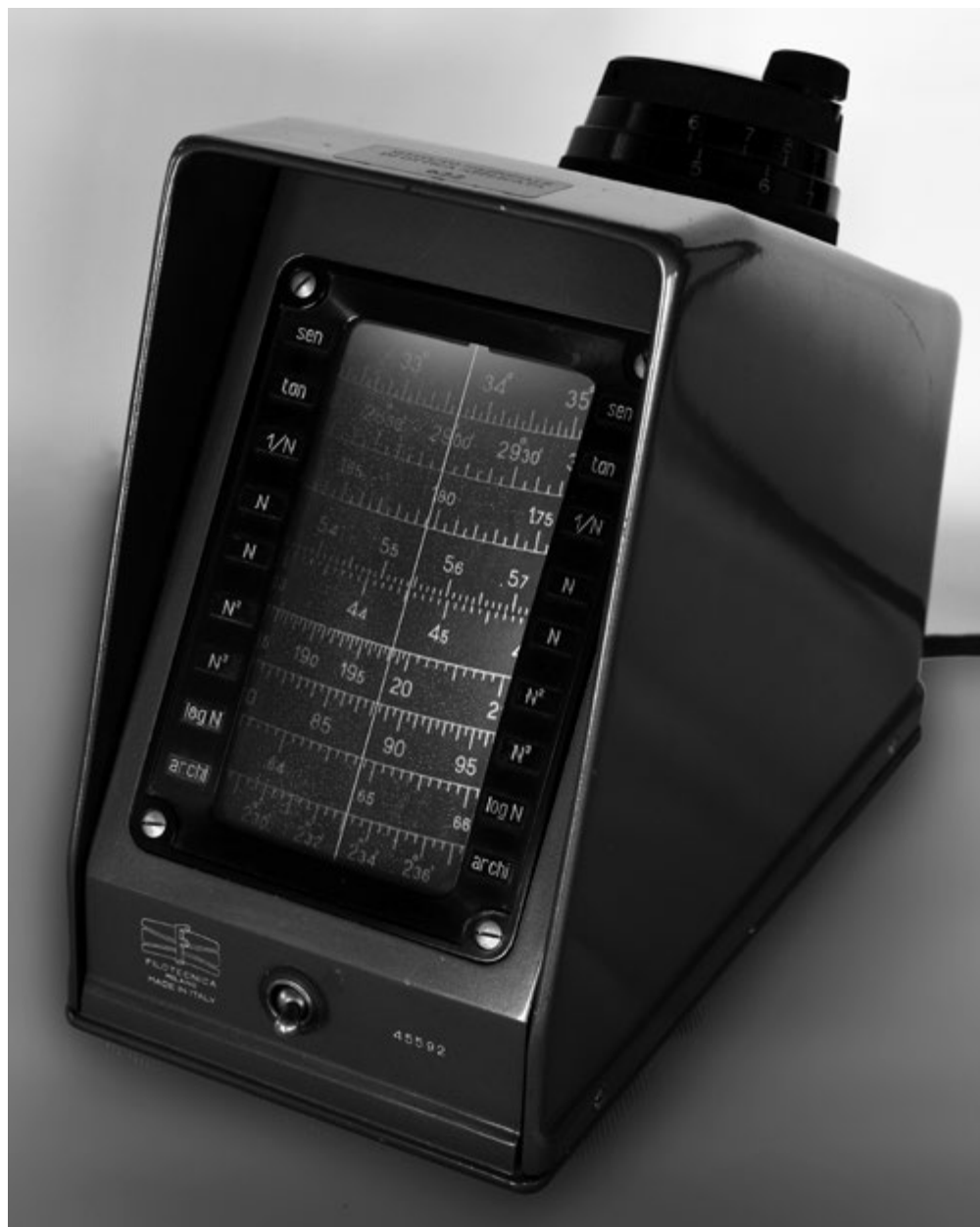
Fig. 11 – Regolo calcolatore ottico: rarissimo strumento di calcolo, tipo regolo, ma con scale ottiche invece che meccaniche per guadagnare in precisione. Utilizzato all'Istituto di Ottica per progettare componenti ottici. [Filotecnica di Milano, inizio Novecento]
