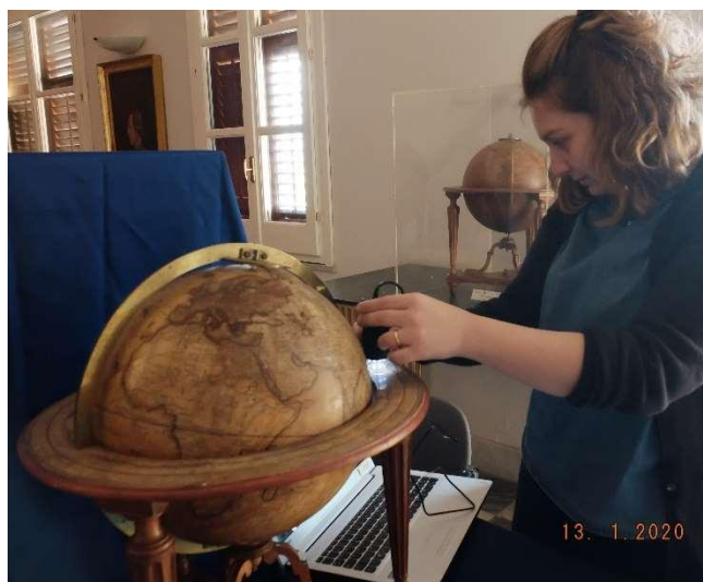
Fig. 3 - Ispezione delle superfici del globo terrestre (R. Bonne, fine XVIII secolo) per mezzo di un microscopio USB digitale portatile.
