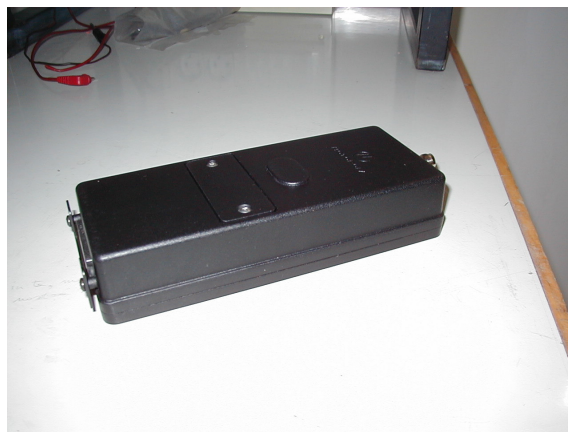
Fig. 1 – Scheda MSITel per gestione TM/TC e modem NAL che costituiscono il modulo di telemetria.
