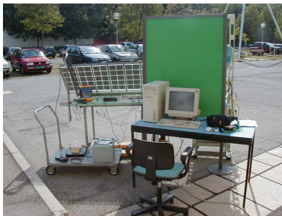
Fig. 6 I test del sistema SPSys integrato con pannello fotovoltaico e batterie
