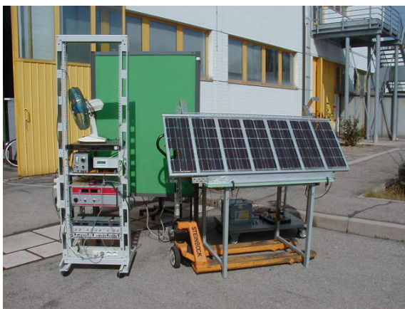
Fig. 6 I test del sistema SPSys integrato con pannello fotovoltaico e batterie
