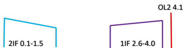
Fig. 6.5 La banda di prima conversione 1IF convertita nella seconda conversione 2IF
