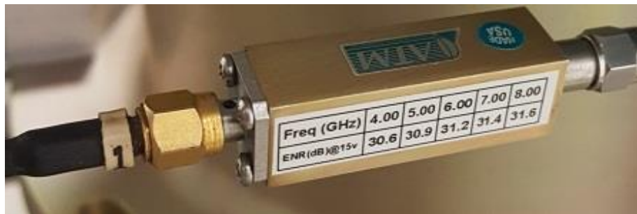
Fig. 2.4 Valori ENR del generatore di rumore ATM NX3248Y
