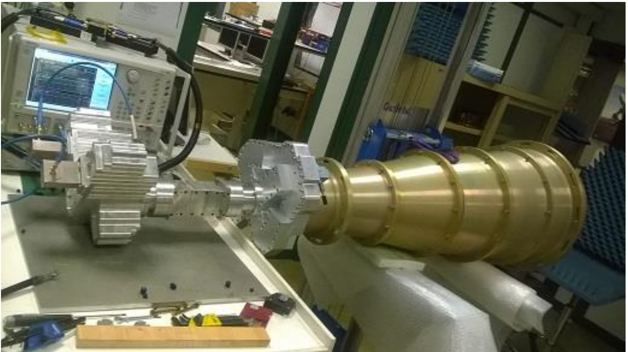
Fig. 2.1 Complessivo Horn+MarkerInjector+polarizzatore+OMT, manca la finestra da vuoto
