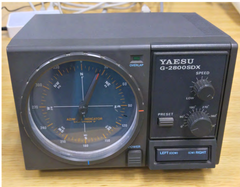
Figura 10: Rotore di antenna, unità interna di controllo
