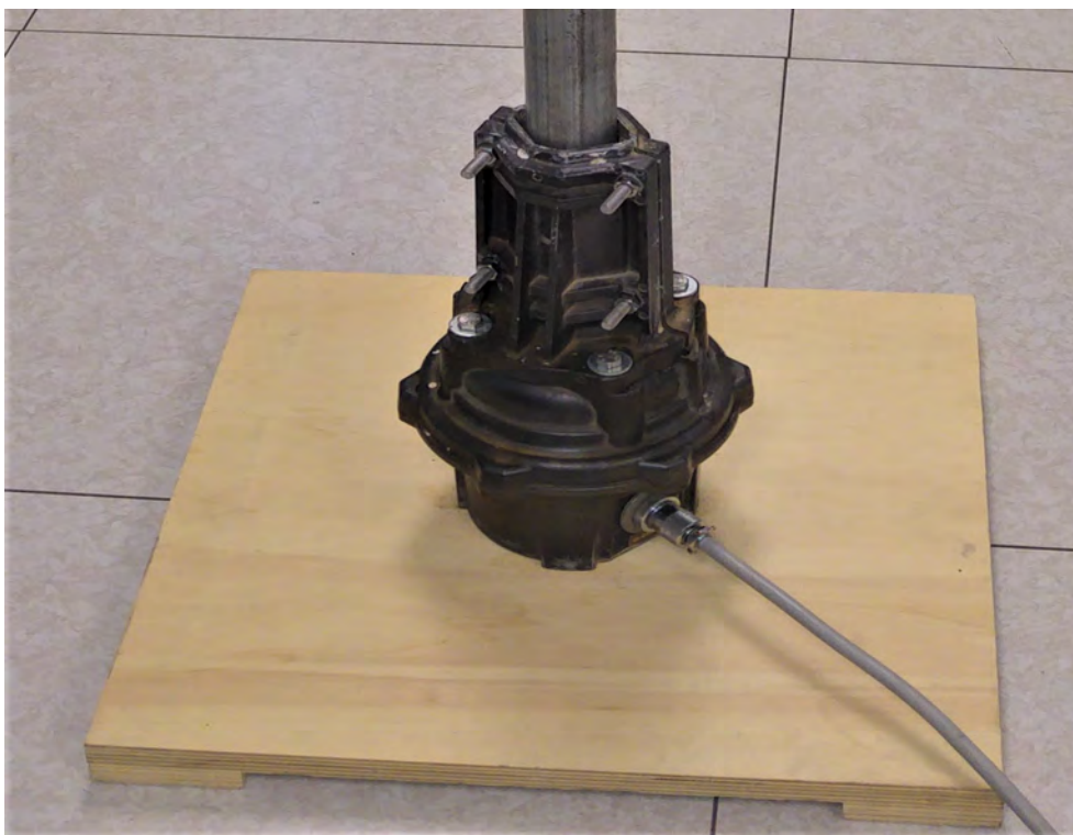
Figura 11: Rotore di antenna, unità esterna di attuazione
