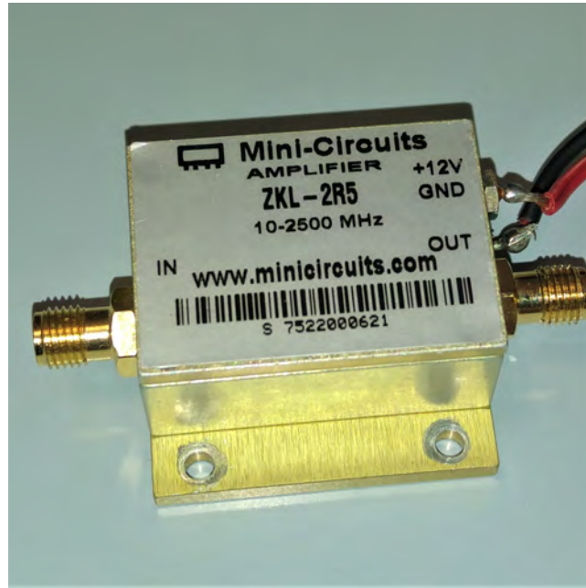
Figura 5: Amplificatore RF MiniCircuits ZKL-2R5, 10-2500 MHz
