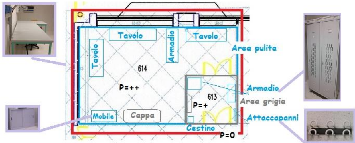
Fig. 1.b Layout dell'impianto Camera Pulita. Vengono evidenziati il vestibolo, la camera, gli arredi e i \Delta P associati.
